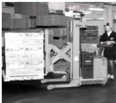
*Para transportar materiales se usa un montacargas con "pallet".*
