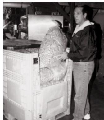
*El doblarse puede ser evitado por el uso de contenedores que se abren de un lado.*
