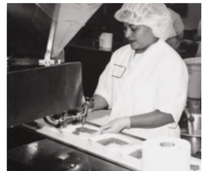
*Dispensador de alimento líquido operado por palanca manual.*
